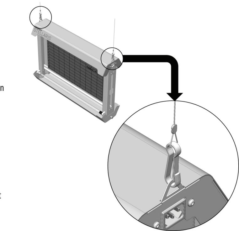
**Achtung:** Stellen Sie vor der Installation des Gerätes sicher, dass die Oberfläche, an der es aufgehängt werden soll, das Gewicht sicher tragen kann.
