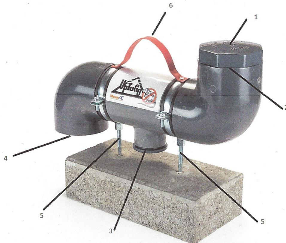
Die obere Öffnung ist über einen luftdichten Deckel (1) mit Dichtung und Schraubgewinde versehen. In diesem Deckel befindet sich ein durchlöcherter Metallstift, an dem der Rattenköder befestigt wird (2).
