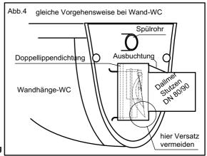
Wichtig: Bei DN 80 sind nur die durch uns mit einer Ausbuchtung versehenen Dallmer Stutzen zu verwenden!
